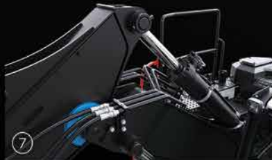
Cojinete del cilindro de la pluma de fundición reforzado
