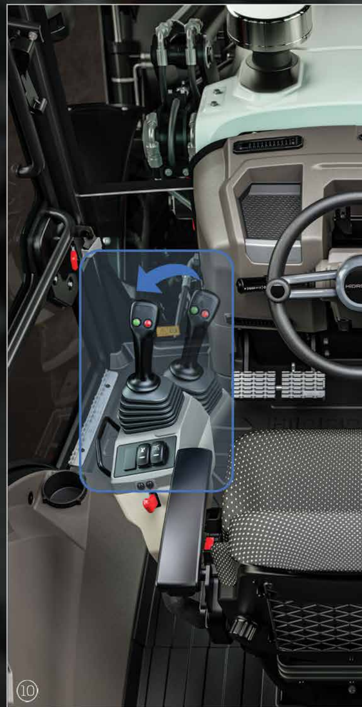
10 El mando izquierdo se inclina hasta cierto grado para que el operador trabaje más cómodamente en el lado de carga
