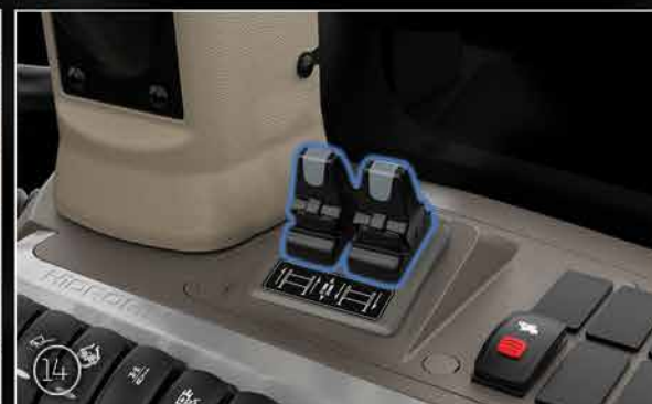
Control proporcional de estabilizadores (**)
